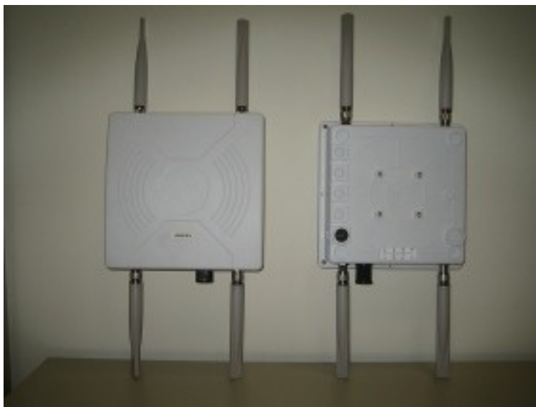
Figura 2.1- Vista frontal (esquerra) i vista posterior (dreta) d'un node qmk . Tant les antenes integrades a la caixa com les exteriors superiors s'utilitzen per a enllaços entre nodes qmk .
