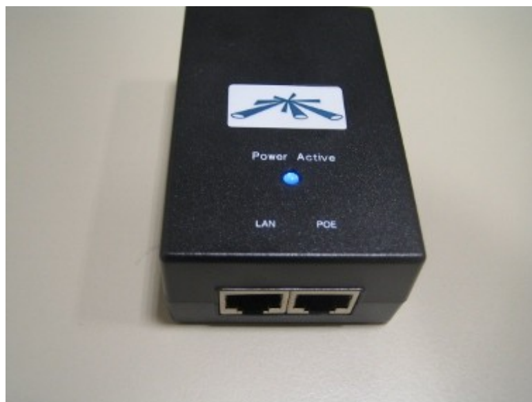
Figura 4.2.- Alimentació a través de POE d'un node qmk .
