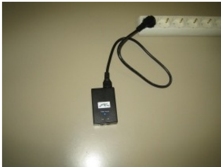
Figura 5.1- . Primer pas de l'engegada d'un node qmk : connexió del transformador a l'alimentació.
